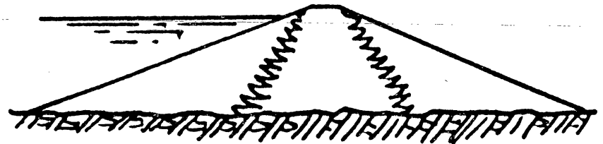
Hydraulic Fill - Section
