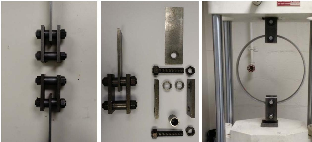
a) Tension test apparatus
